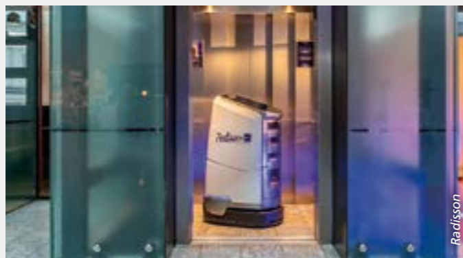
■ Dank Cloud-Technologie kommunizieren die Lifte direkt mit dem Roboter.
